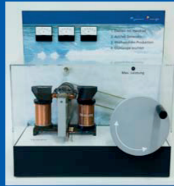
Kleinstkraftwerk mit Handantrieb
