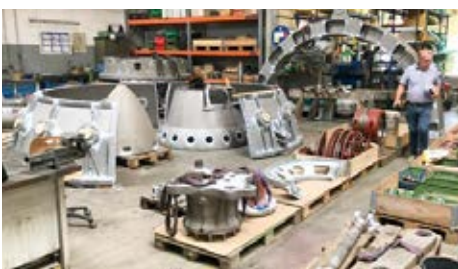
Geordnetes Chaos: Die Turbinenteile in der Auslegeordnung im Herstellerwerk. Jedes Einzelteil wird gereinigt, geprüft, dokumentiert und wenn nötig revidiert.
