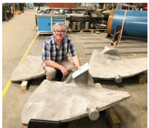
Neue Laufradflügel: Die alten Laufradflügel haben nach 54 Jahren ausgedient. Auf dem Bild sind bereits die neuen Rohgussteile aus der Türkei zu sehen. Mit dem strömungstechnisch optimierten Laufradprofil lässt sich künftig mehr erneuerbarer Strom erzeugen.
